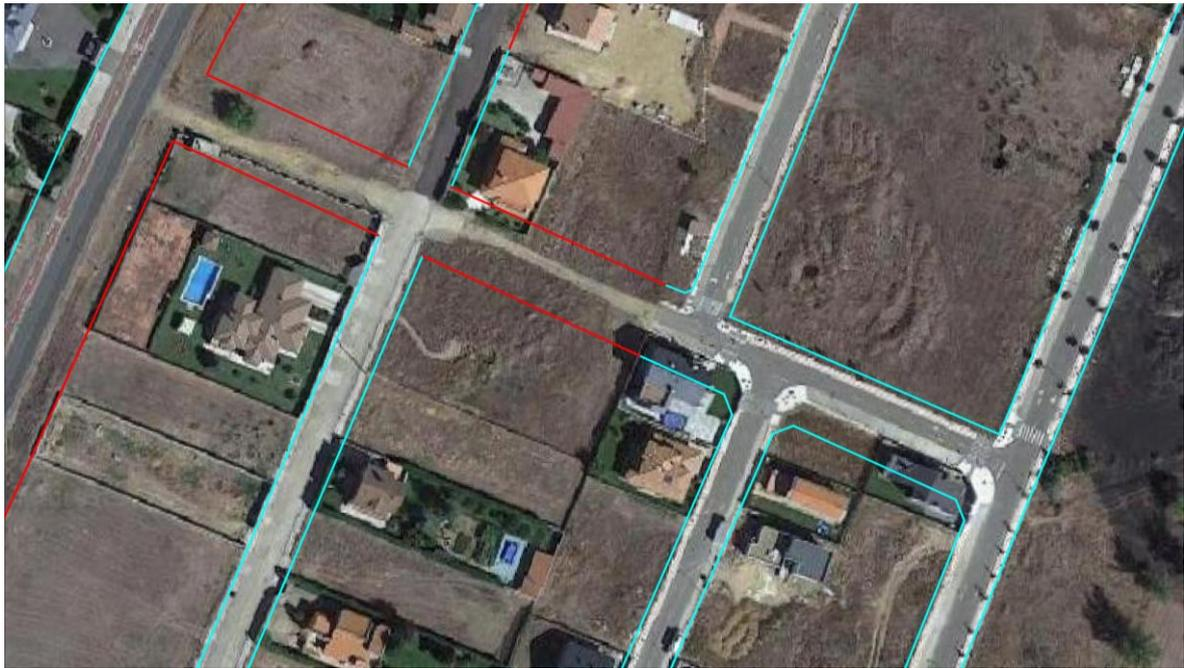
Figura 8. Plano superpuesto de las alineaciones del PGOU vigente sobre ortofotografía
